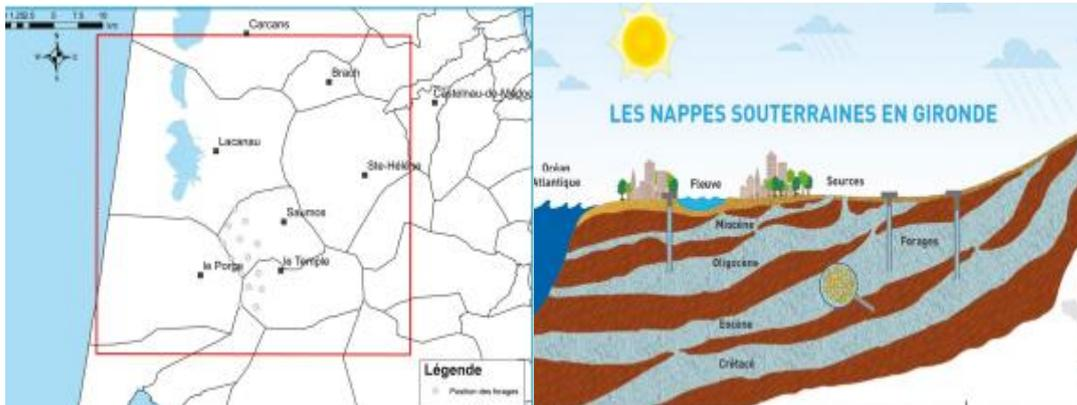
**Définition d'un champ captant :** un champ captant est un ensemble de forages, fonctionnant conjointement pour capter l'eau d'une même nappe et acheminer l'eau jusqu'à une station de pompage.
